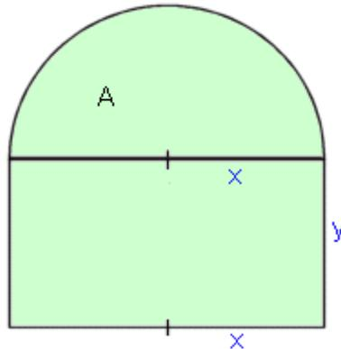
Zielfunktion:  $u(x,y) = 2x + 2y + \pi x$  soll minimal werden
